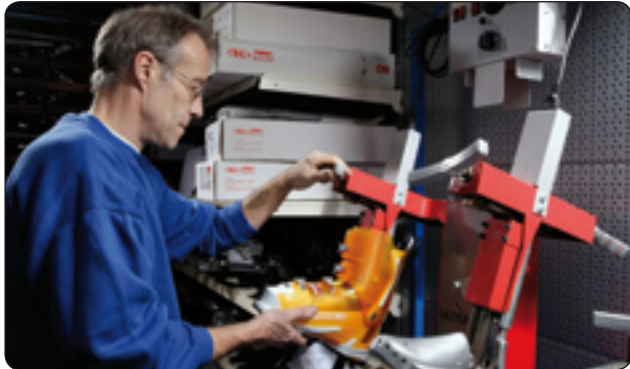
Schuhe weiten mit einer speziellen Maschine
